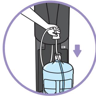
12. Deslice el adaptador de la botella sobre el cuello de la misma, asegúrese de que el tubo golpee la parte inferior de la botella y empuje hacia abajo para asegurar.
